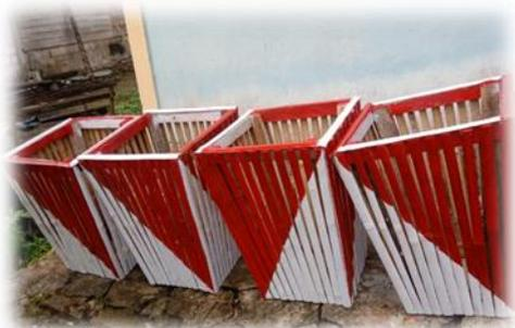
Gambar 4 menyajikan hasil kerangka tong sampah setelah pengecatan dan siap pakai. Pembuatan tong sampah ini terbuat dari bahan-bahan praktis dari alam yang mudah didapatkan tanpa mengeluarkan biaya yang banyak di Desa Hilidohona.
